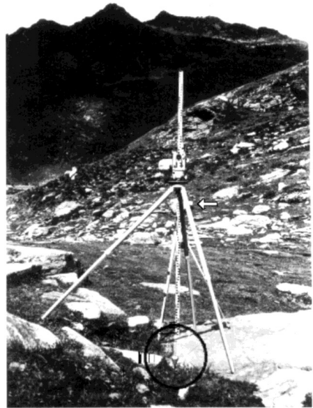
3 Vermessungsinstrumente. Das Lot (durch einen Kreis markiert) steht über dem Beobachtungspunkt des Schalensteins West, die Meßlatte weist exakt nach Norden. Direkt unter dem Theodoliten (Pfeil) erkennt man in 32 megalithischen Ellen Entfernung den Nordvisur-Menhir
